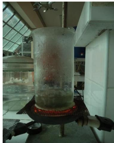
Figura B.8 Ebullición en HCl 2N
