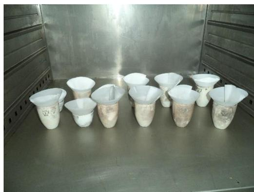
Figura B.10 Filtrado secado en estufa (60°C)
