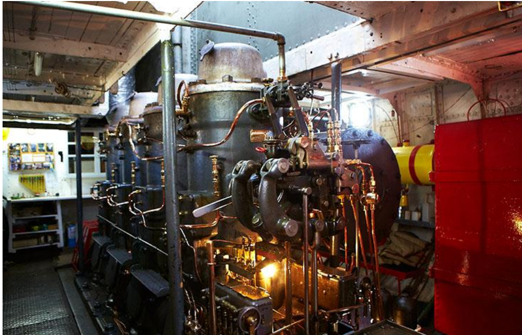
IMAGEN N° 35: Vista del motor Bolinder sueco semi-diesel de 4 cilindros ubicado en la sala de máquinas. FUENTE: Autor de la Investigación. 2015.
