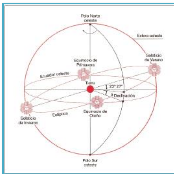
Figura 2.8. Movimiento relativo de la tierra respecto al sol Fuente: Monográfica Técnica. Compañía Roca Radiadores, SA., 2011
