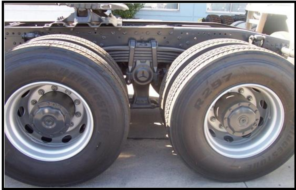
Fig. 3.15. Suspensión reforzada de 18000 kg por eje del volquete volvo FMX 440
