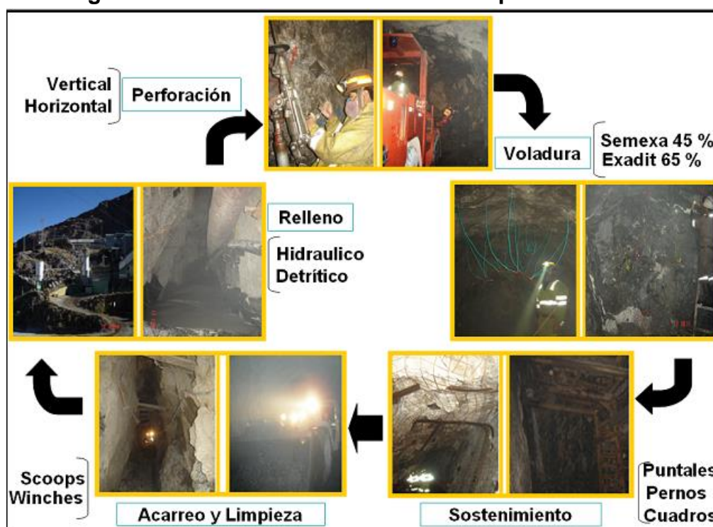
Fig. 3.8. Ciclo de minado de la Unidad Operativa de Arcata
