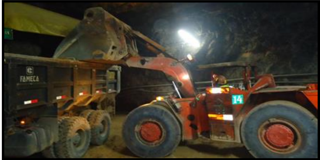
Fig. 3.18. Carguío de scoop HSC 063
