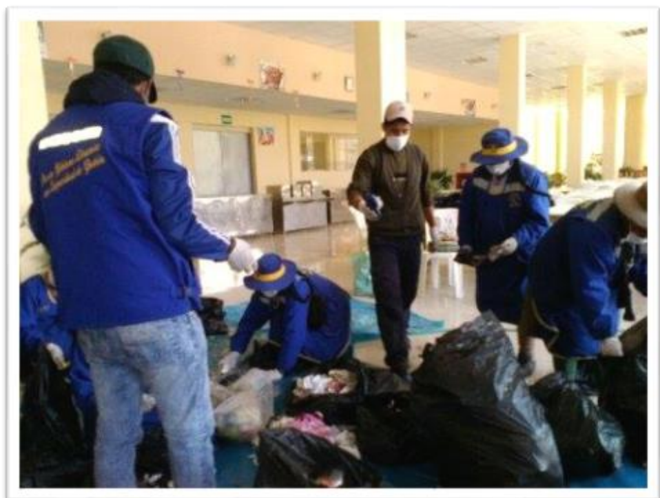
Figura H.8. Segregación de RSD para determinar la composición de residuos sólidos del distrito de Antauta.
