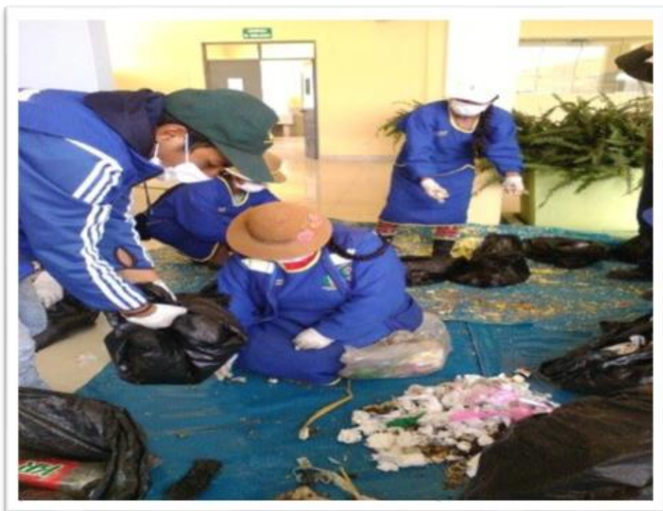
Figura H.6. Segregación de RSD para determinar la composición de residuos sólidos del distrito de Antauta.
