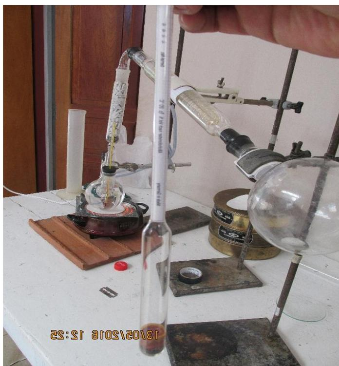
Fotografía N° 8: Medición de alcohol
