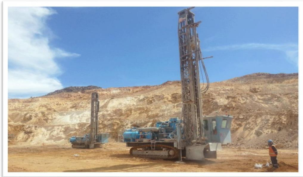
**Foto 5.** Operación de perforación para producción, buffer y precorte.
