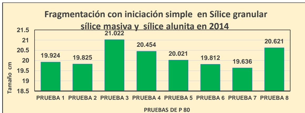
**Figura 5.33.** Fragmentación con iniciación simple en sílice granular, masiva y alunita.
