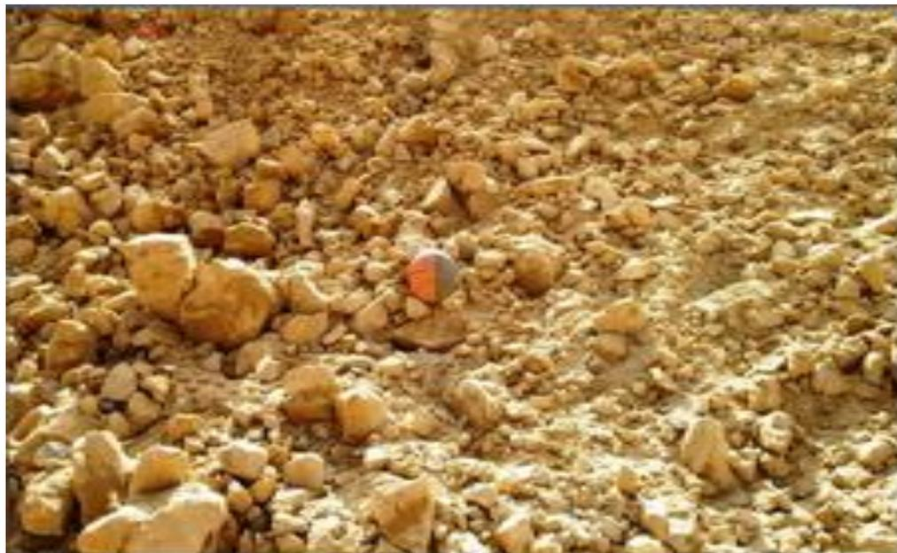
**Figura 5.53.** Imagen fragmentación con Wip frag voladura banco 4112-PY 05.
