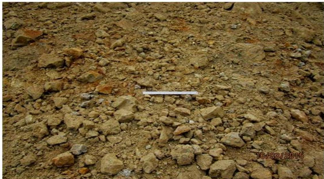
**Figura 5.87c.** Resultado de Fragmentación con Wip frag 2010 en producción.
