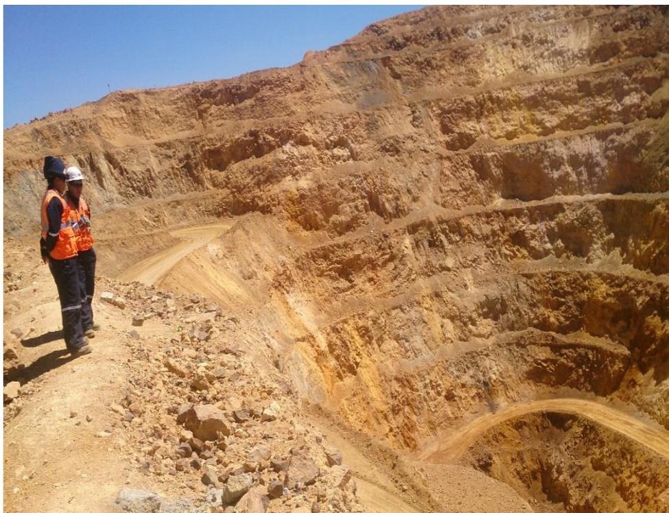
**Foto 2.** Personal de perforación evaluando el resultado de voladura de precorte.
