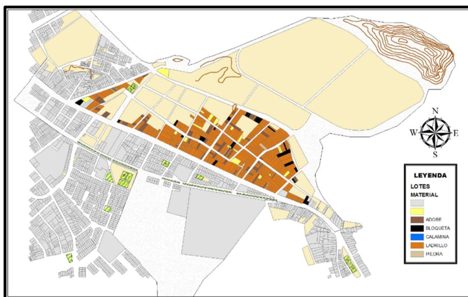
**Figura 107.** Materiales de Construcción.
