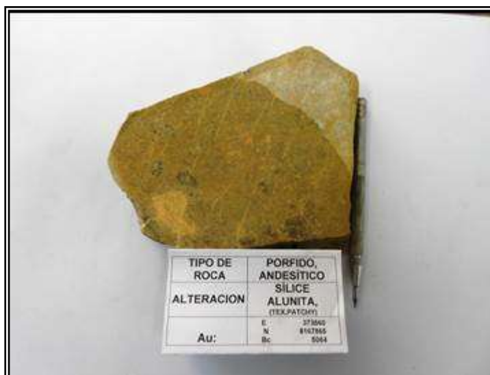
Figura 23: Muestra de mano de sílice alunita con óxidos de hierro.
