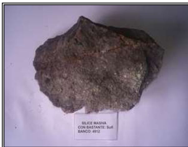
Figura 38: Muestra de mano de una sílice de mano con contenido minerales de sulfuros de py diseminada para análisis MEB.
