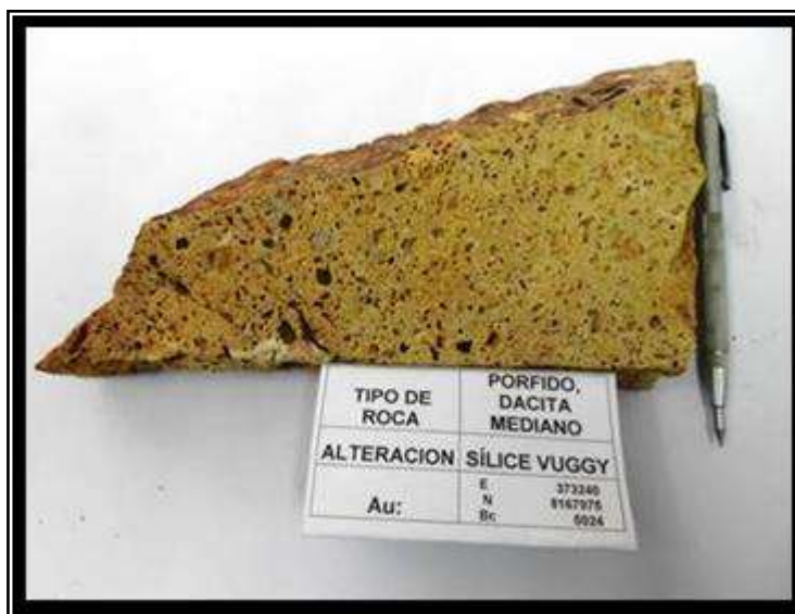
Figura 22: Muestra de mano de una Sílice Vuggy con óxidos de hierro.
