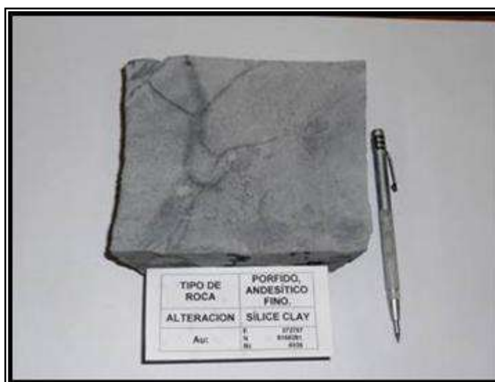
Figura 24: Muestra de mano de Sílice Clay con contenido de pirita diseminada.
