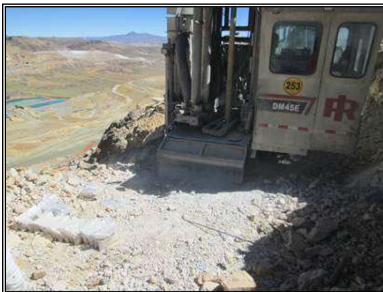
Figura 15: Perforación de Infill Drilling y recolección de muestra en detrito del sondaje.
