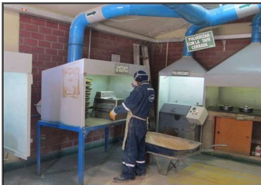
Figura 18: Equipo de chancado y pulverizado, de muestras extraídas de la zona de estudio.
