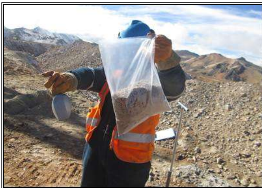
Figura 13: Toma de muestra de mineral adecuado de 3 Kg.
