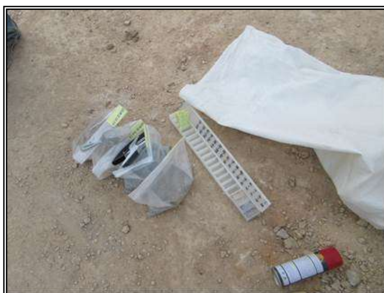
Figura 16: almacenamiento de detritos en los Chip Trays como testigos de la mineralización.
