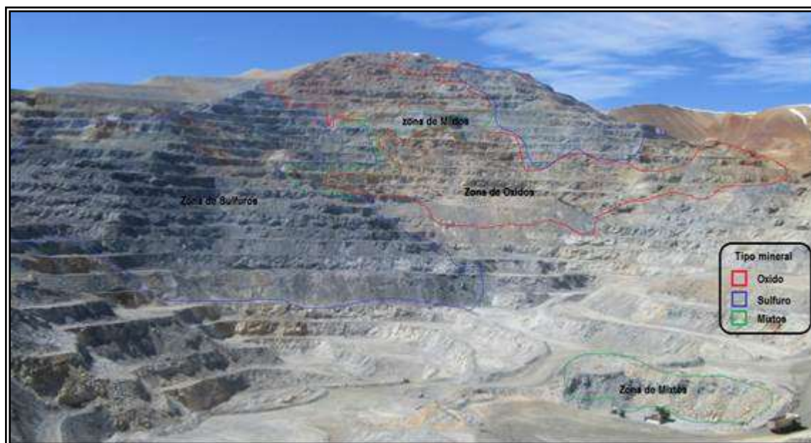
Figura 25: Vista del Tajo Tucari mirando al Este, interpretando el tipo de Mineral.
