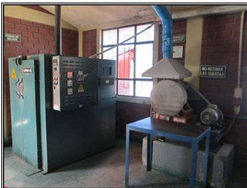
Figura 17: Preparación de muestras por el laboratorio químico de Tucari (secado).
