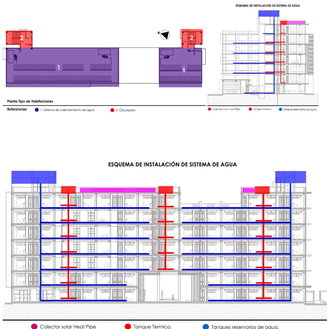
Esquema 39: Esquema de instalación del sistema de calentamiento Fuente: Elaboración propia
