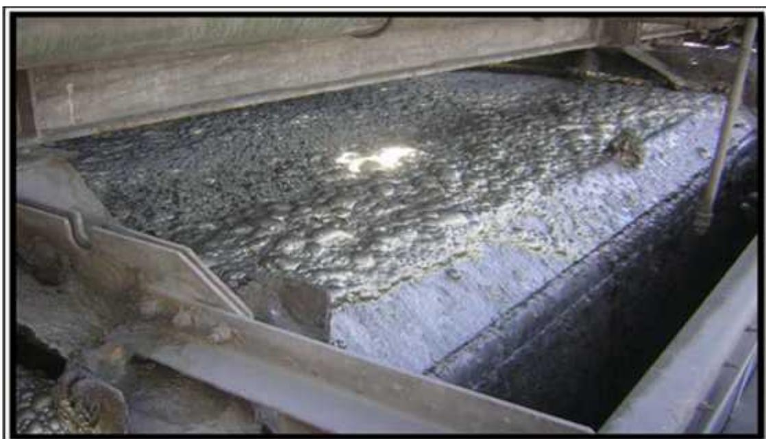
**Figura 10.** Celda de flotación
