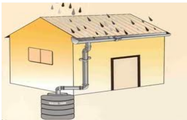
Figura N° 03: canaleta de recolección de agua de lluvia en techos
