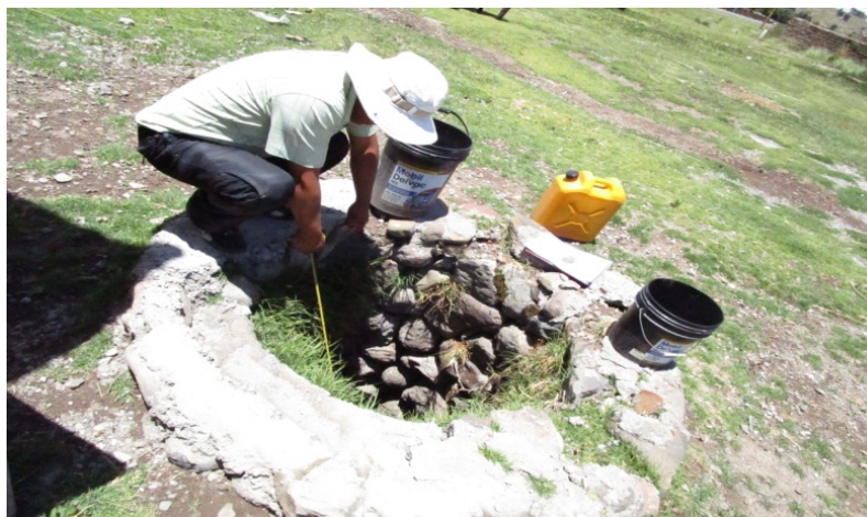
Figura N° 13: Medición del área y la profundidad del pozo rustico – 2015. Fuente: Elaboración Propio
