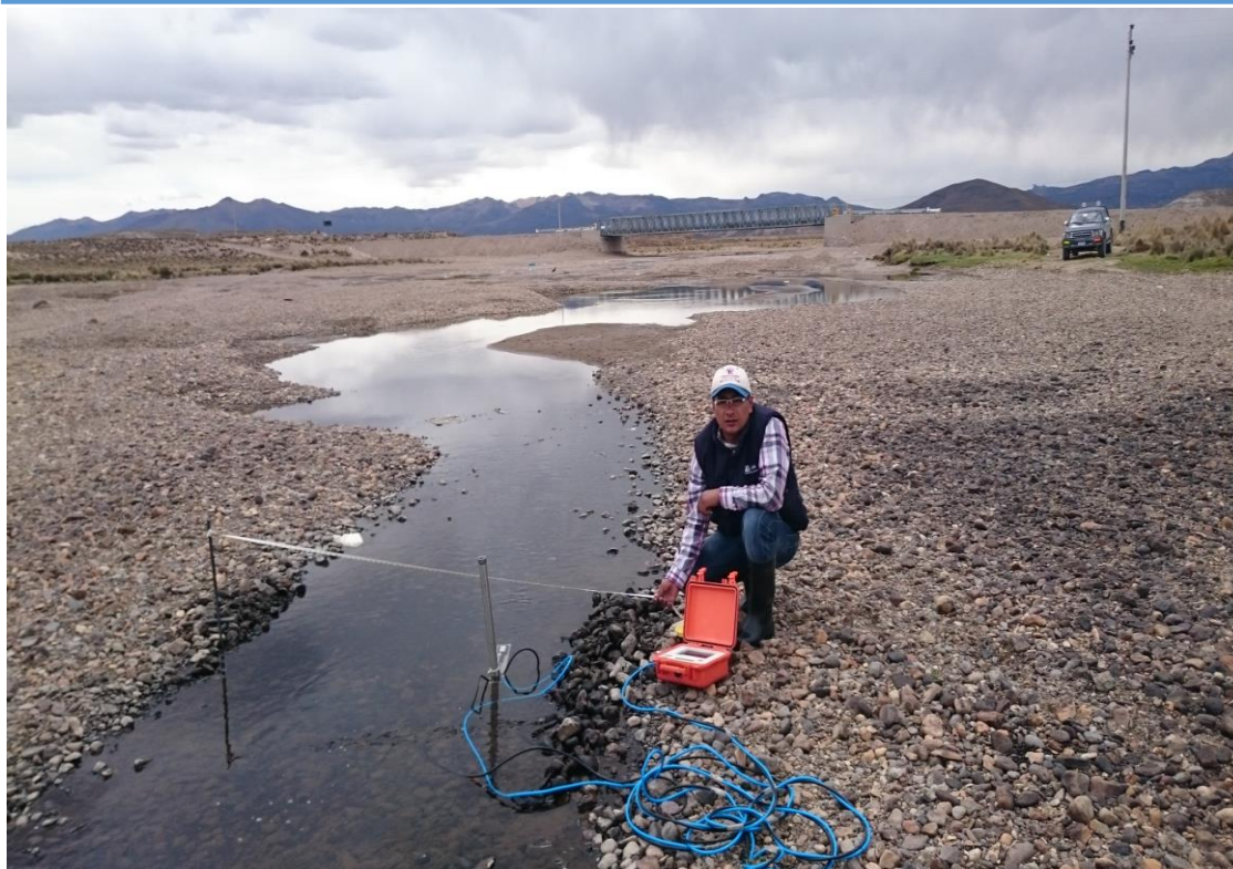
Fotografía N° 02 , Se Observa el aforo realizado en el rio Santa Rosa con el correntómetro tipo Ultrasonido (AV-flowmeter-Mainstream P3037) ubicado en la Sub Cuenca Medio Alto llave
