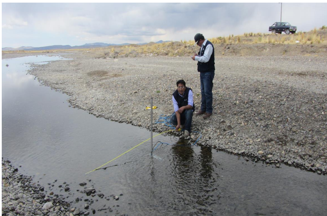
Fotografía N° 03 , Se Observa el aforo realizado en el río Cutimbo con el correntómetro tipo Ultrasonido (AV-flowmeter-Mainstream P3037) ubicado en la Sub Cuenca Agua Calientes
