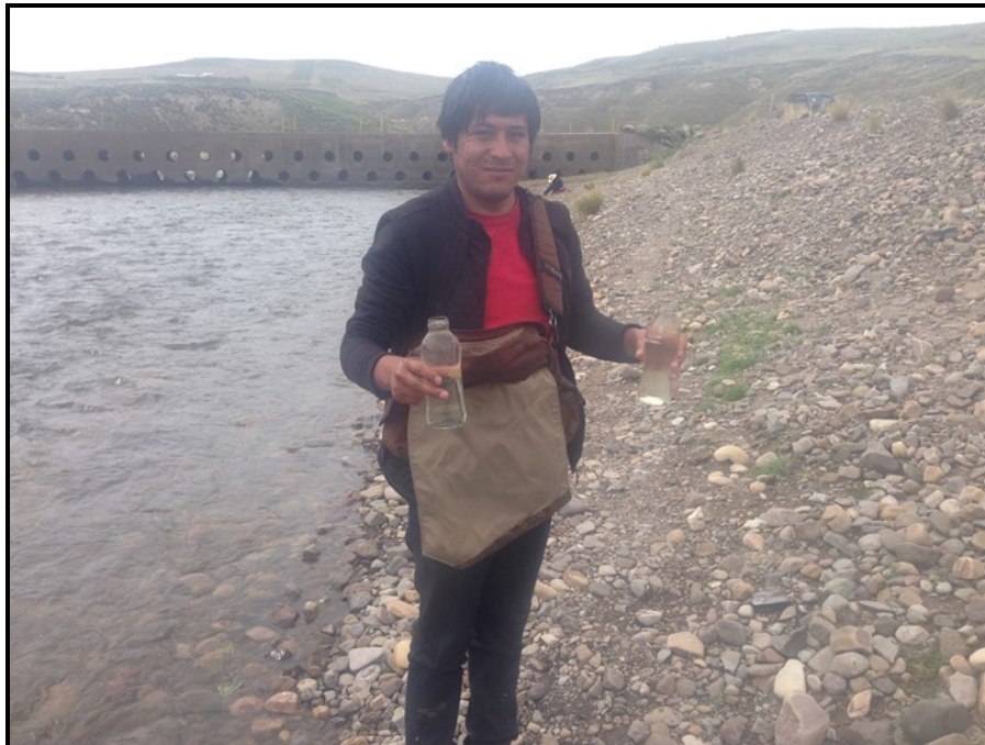
Fotografía N° 09: Se está realizando la toma de muestra en envases de vidrio en el río Ocoruro.
