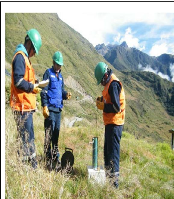
Medición manual de nivel de agua con sonda
