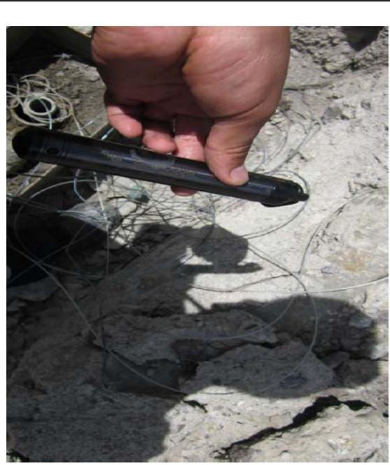
Levellogger, equipo de medición automático, instalado en todos los pozos de la investigación.
