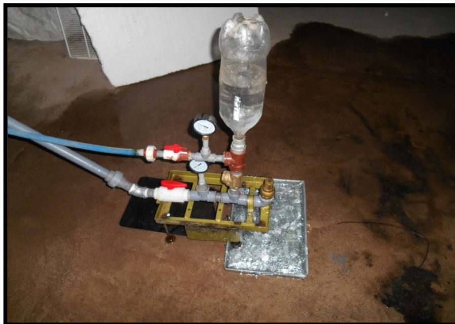
Fotografías 19: Montaje completo de la bomba de ariete hidráulico En funcionamiento
