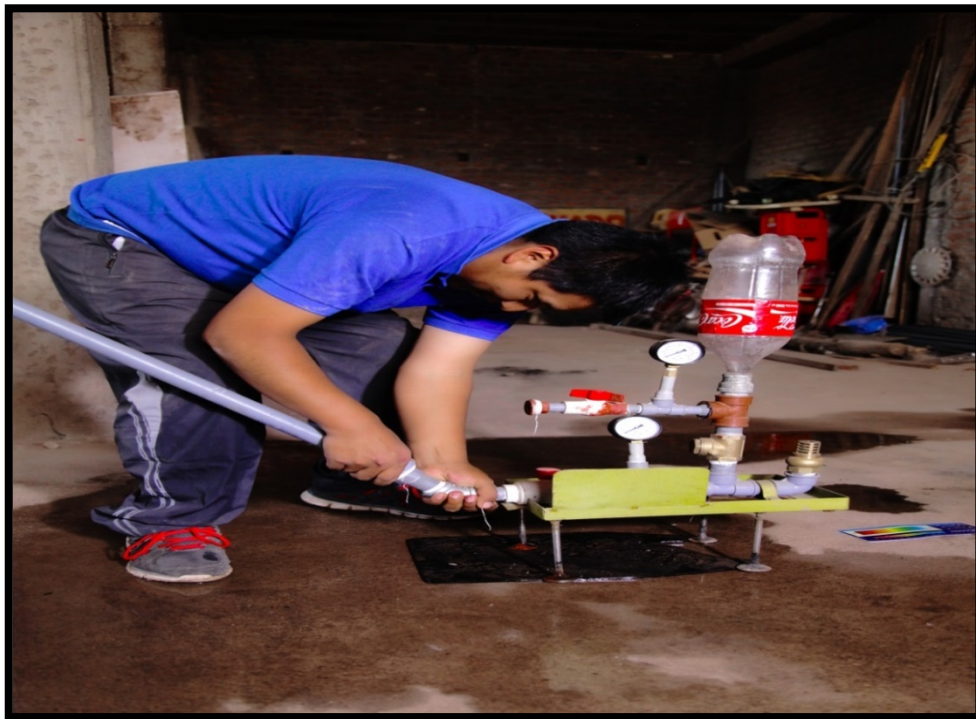
Fotografías 6: Se aprecia la instalación de la tubería de ingreso.
