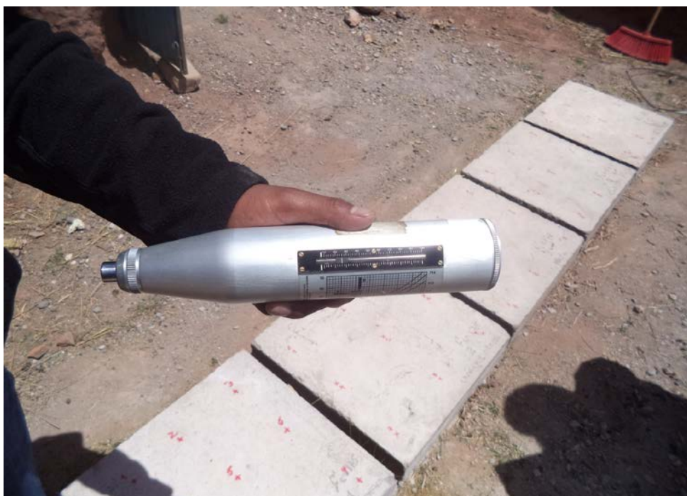
VISTA 07: EN LA VISTA SE MUESTRA EL EQUIPO DE SCLEROMETRO Y LAS LOSAS DE CONCRETO A SOMETER LA PRUEBA.
