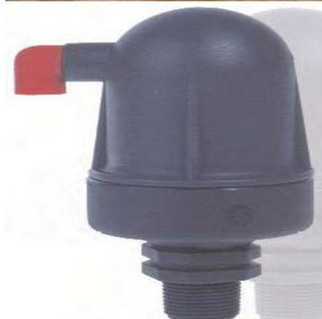
Las válvulas de aire o ventosas se usan para purgar o expulsar el aire que se acumula en las tuberías, sobre todo en las partes altas, reduciendo la sección en el tubo para el paso de agua o taponándolo, o incorporar el aire a ellas cuando están vacías, evitando el aplastamiento. Además evita que se originen compresiones y dilataciones alternadas por la elasticidad de las burbujas de aire causando sobre presiones. El desplazamiento brusco de las masas de aire puede provocar golpes de ariete.
