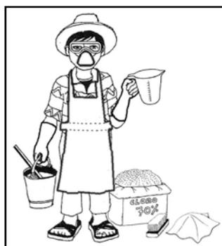
Con el mandil, los anteojos y la mascarilla puestos dejar pasar el agua clorada retenida en la Tubería de la Línea de Conducción, de ser necesario se prepara nuevamente la mezcla de agua con el Hipoclorito al 70% (según anexo), mantener el agua clorada en la Cámara Rompe Presión por aproximadamente 2 horas.
