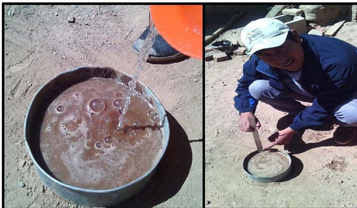
**En la imagen se observa el vaciado de agua y el registro del descenso de agua en el anillo simple.**
