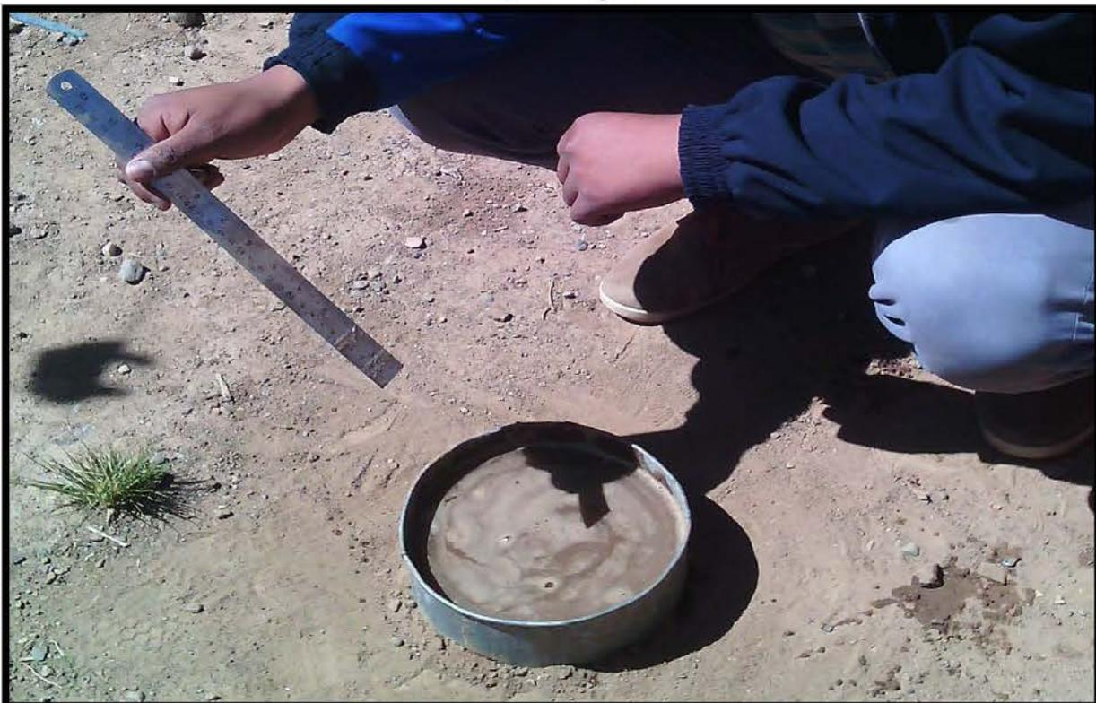
**En la imagen se observa el anillo simple con agua y la regla para medir al altura de agua**
