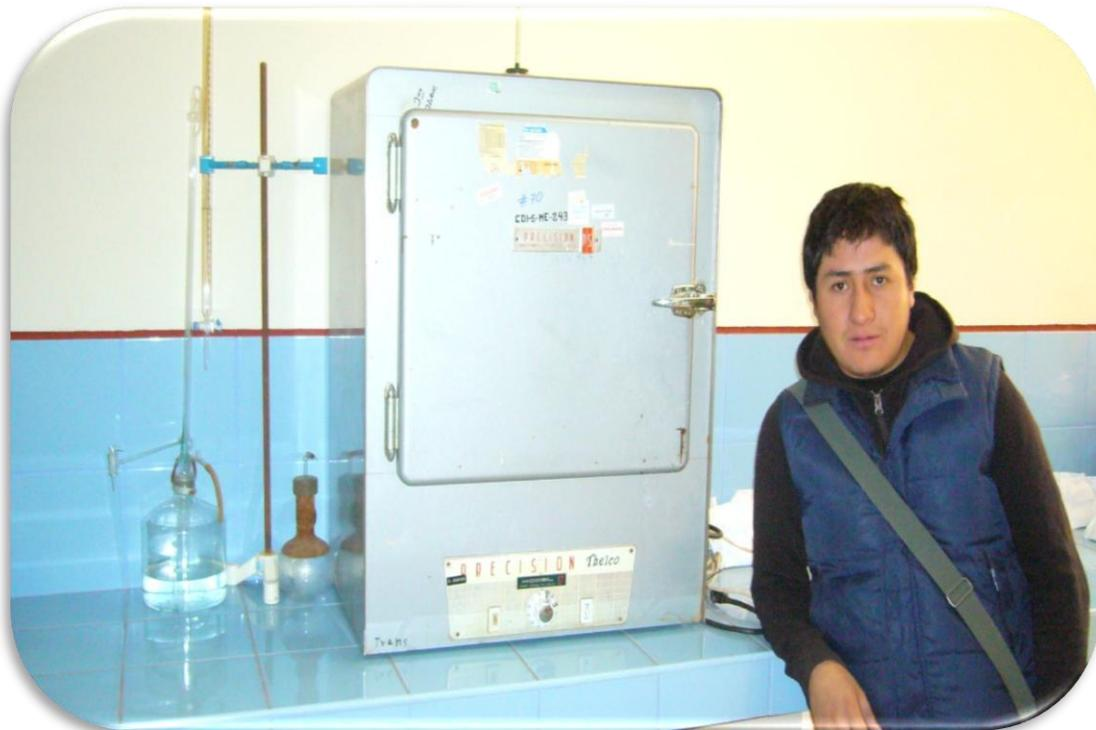
**FOTOGRAFÍA Nº 12 – PROCESO DE SECADO PARA LA DETERMINACIÓN DE CONCENTRACIÓN DE SÓLIDOS**
