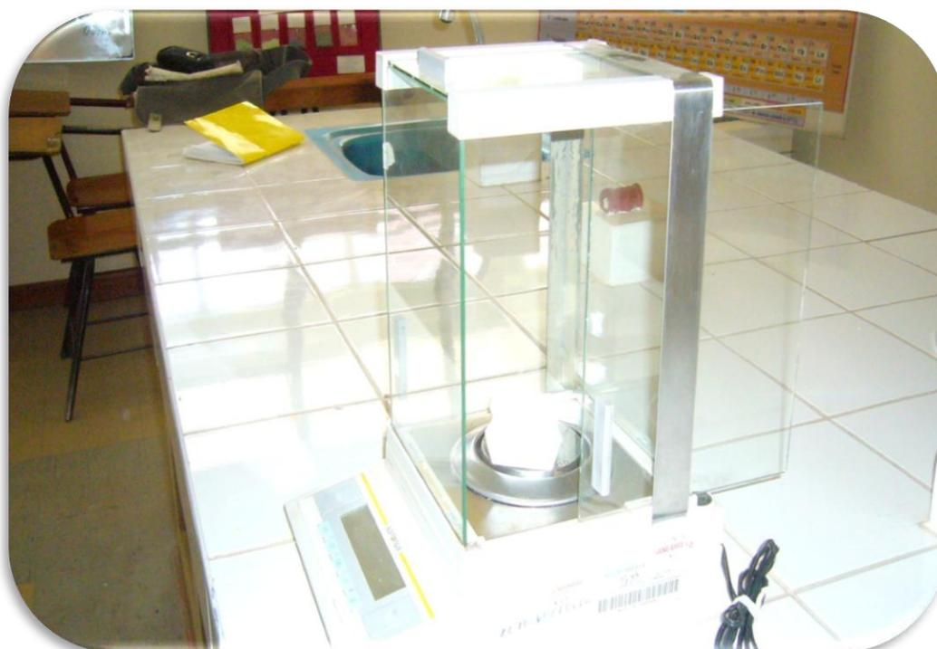
**FOTOGRAFÍA Nº 10 – BALANZA PARA DETERMINAR LOS PESOS DE LA MUESTRA**
