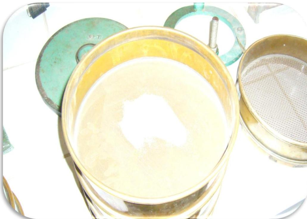
**FOTOGRAFÍA N° 08 – TAMIZADO DEL MATERIAL DEL RÍO COATA PARA DETERMINAR LA CURVA GRANULOMÉTRICA**
