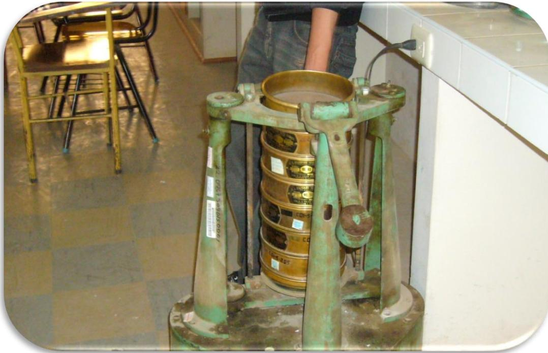
**FOTOGRAFÍA N° 07 – TAMIZADOR MECÁNICO**
