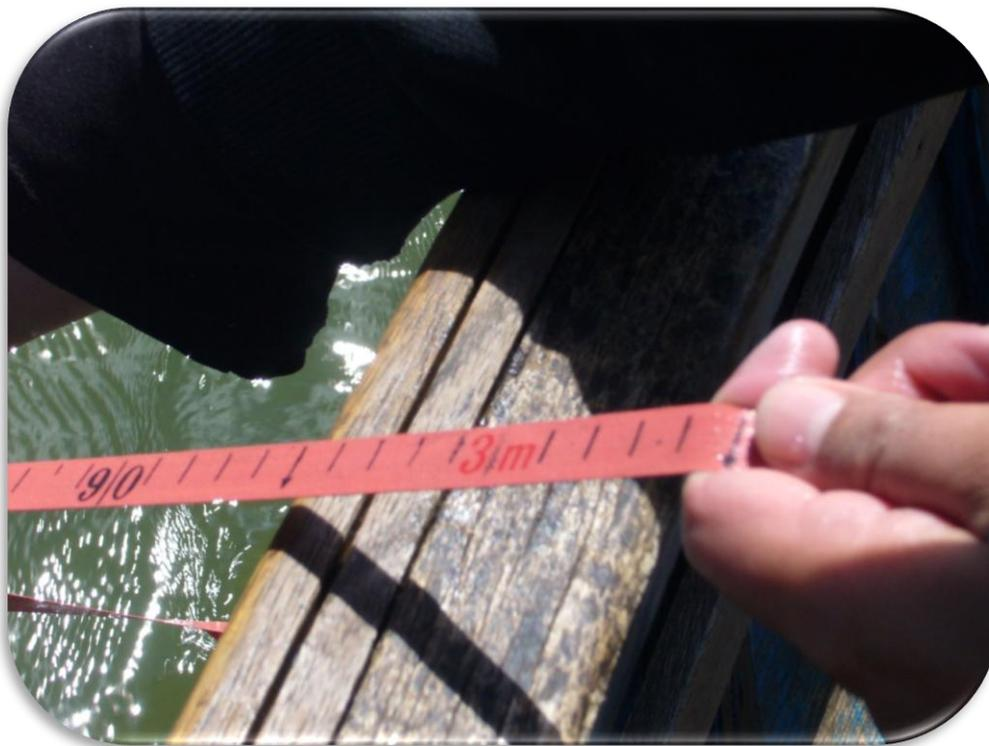
FOTOGRAFÍA Nº 05 – MEDICIÓN DE ALTURA MÁXIMA DE TIRANTE DE RÍO COATA
