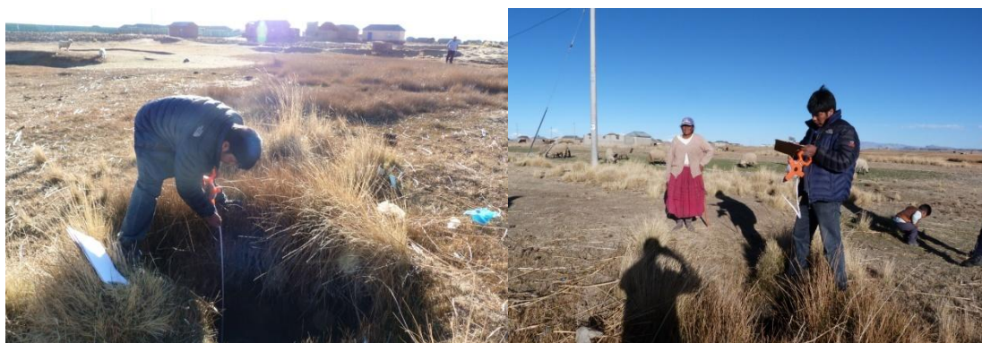
Figura 12: Medición del área y la profundidad del pozo rústico – 2013. Fuente: Elaboración Propio
