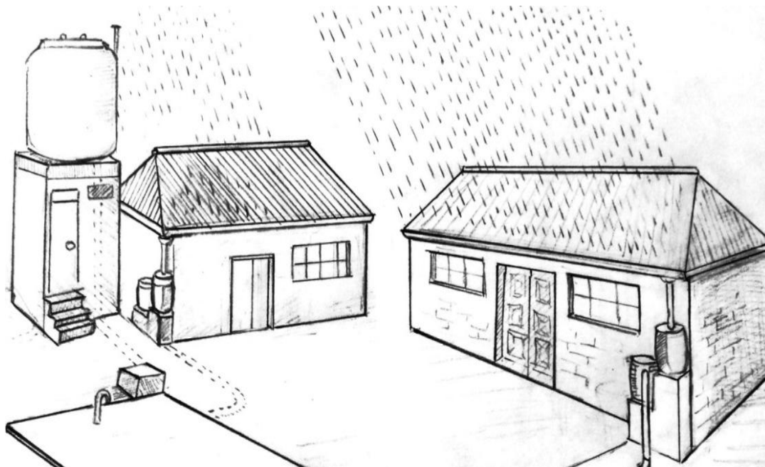
Figura 01: Sistema de captación de agua de lluvia en techos – 2013. Fuente: Elaboración propia
