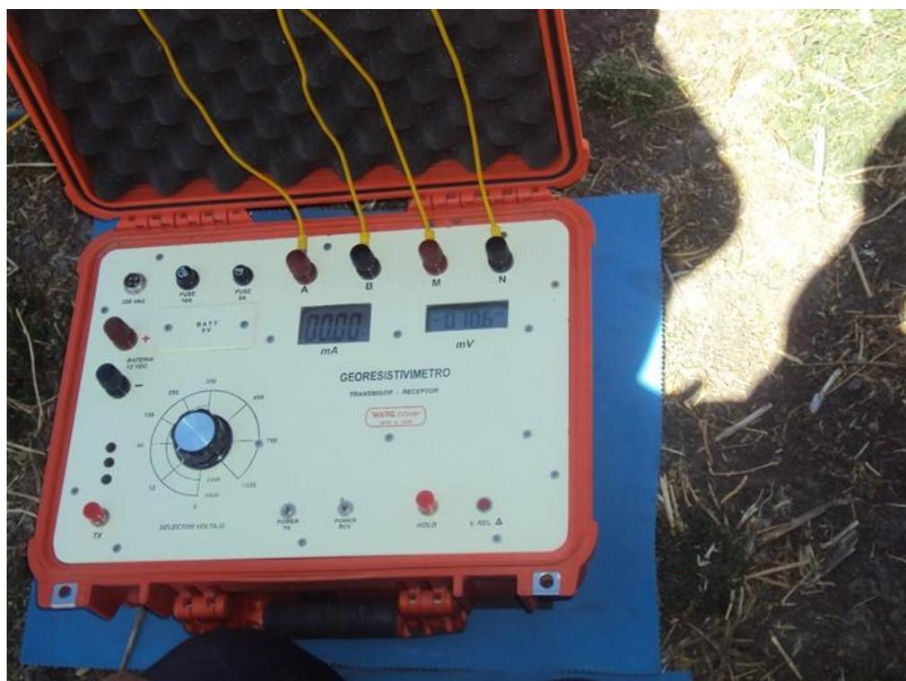
*Fig. N° 19: Georesistivimetro de prospeccion geofisica*
