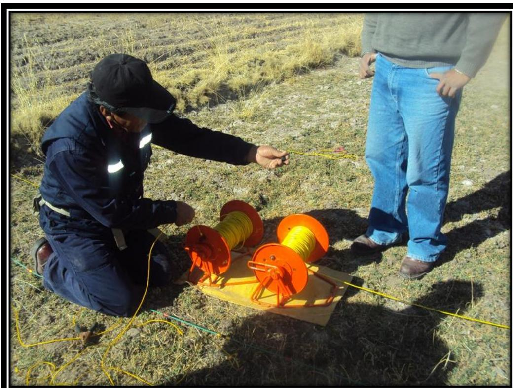
FOTO N° 04: Tendido de cable por parte del geofísico indicando la forma de manipular el cable durante el proceso de trabajo
