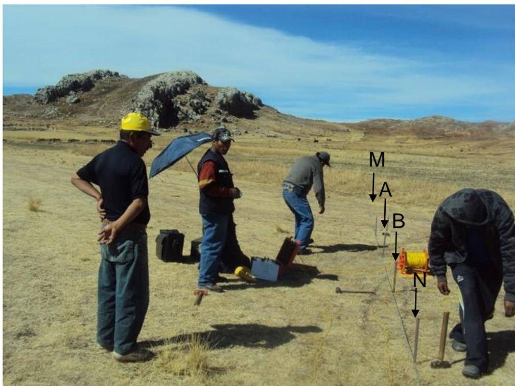
**Fig. Nº 21:** En el presente panel se observa la instalacion de SEV 06 en donde se indica la instalacion de los electrodos en ambas direcciones aplicando el metodo Schlumberger.
