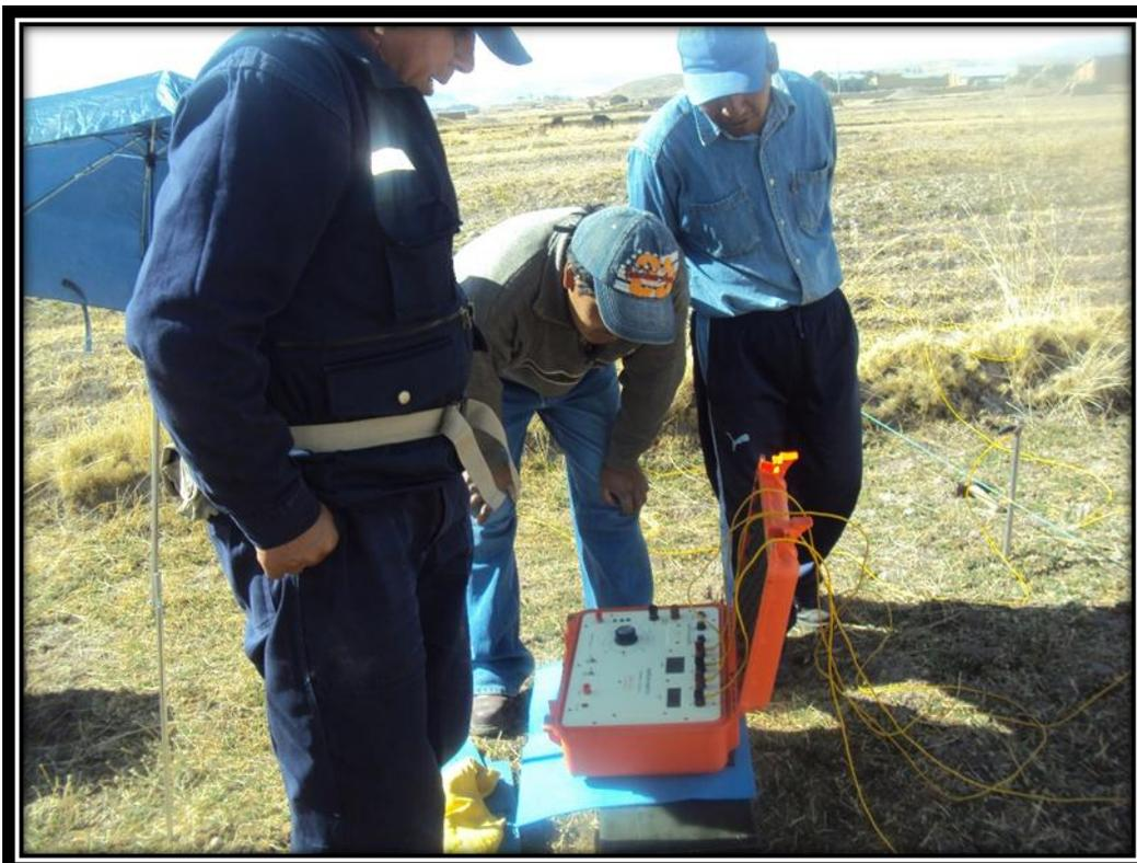
FOTO N° 06: Se aprecia el inicio de trabajos del sondaje eléctrico vertical con un Georesistivímetro
