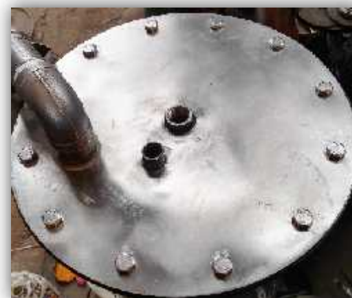
Figura N° 16: Bridas de unión para los cuerpos del RAFA.
