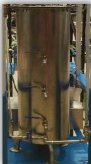
Figura N° 10: Reactor Anaeróbico de Flujo Ascendente (RAFA).
