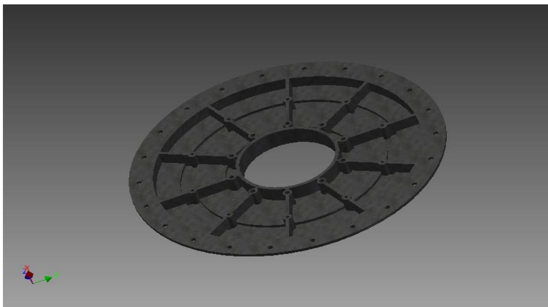
Figura 24. Diseño del cabezal del molino B
