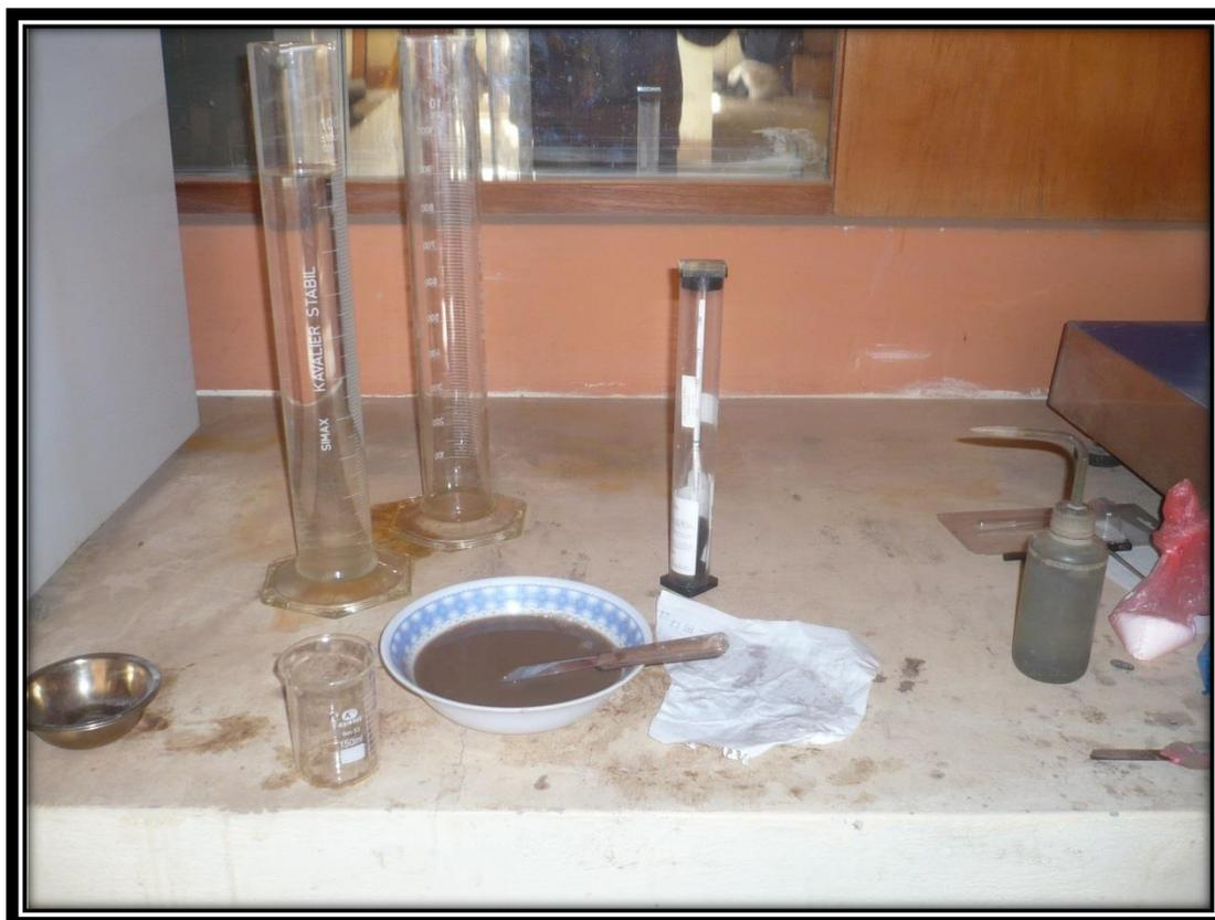
FOTO 14. Fotografía de inicio del ensayo de granulometría por hidrómetro.
