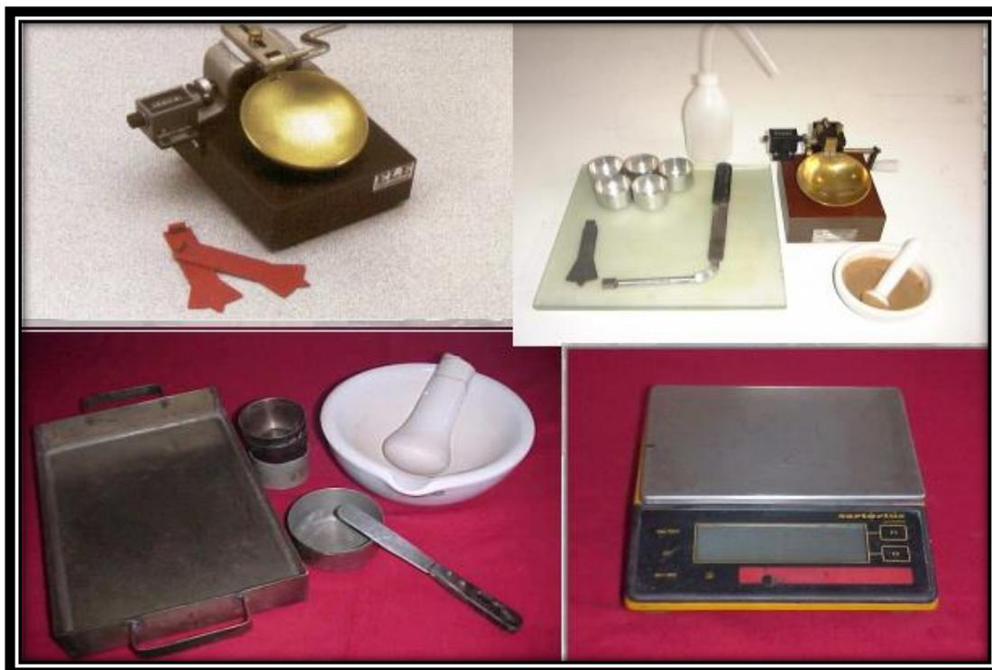
FOTO 17. Equipos y herramientas a utilizar para la obtención del LL, LP y el IP
