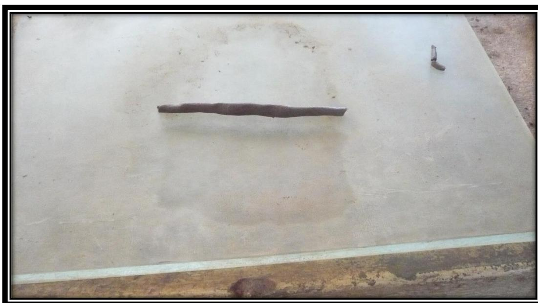
FOTO 18. Amasado de la muestra hasta llegar a 3mm y que ya presente agrietamientos en su estructura.
