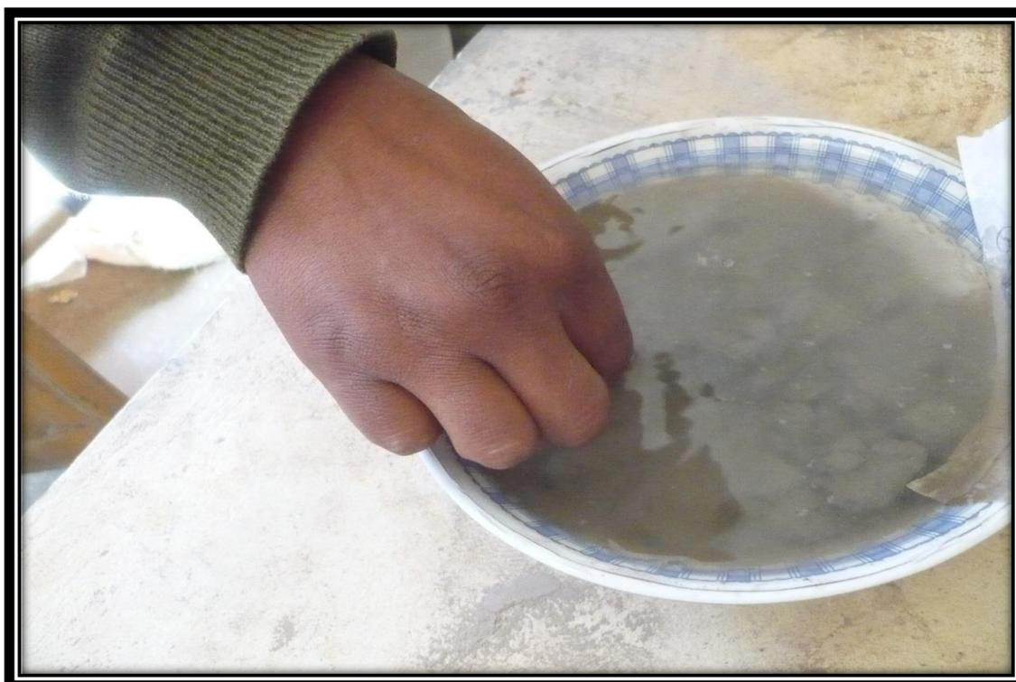
FOTO 10. Fotografía de la muestra procediendo a ser saturada para constatación de que el material es más finos que arena.
