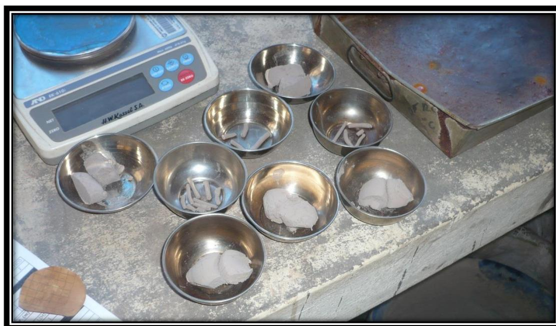
FOTO 20. Conclusión de la toma de datos, una vez terminado de pesar las taras con las muestras secas se procede a llenar las hojas de cálculo en gabinete para obtener la recta que permitirá identificar el Índice de Plasticidad.
