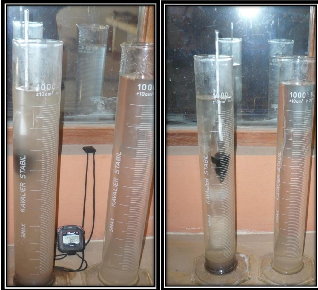
FOTO 16. Fotografía tomando el tiempo y realizando la lectura del hidrómetro.
