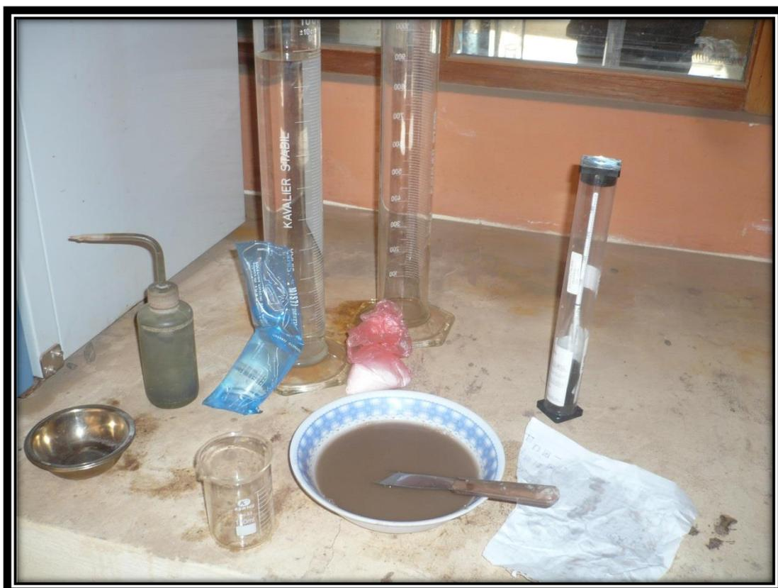
FOTO 11. Fotografía de los materiales y equipos a utilizar para la granulometría con hidrómetro.
