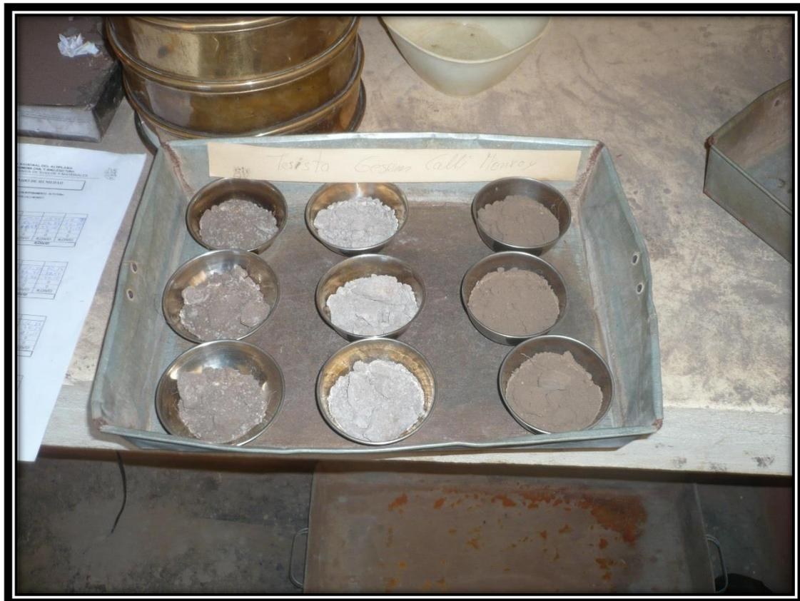
FOTO 21. Fotografía de las muestras inalteradas tomadas en la calicata; 3 muestras a distinto nivel, las primeras 3 hacia el nivel del terreno, las segundas a 0.80 m. de profundidad y las terceras hacia la base de la calicata a un promedio de 1.60 m de profundidad.
