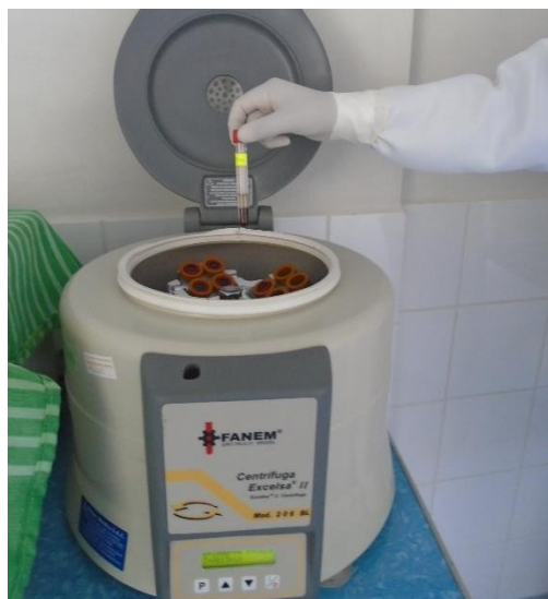
Img. 31 Centrifugación a 3000 r.p.m., por un tiempo de 15 minutos.
