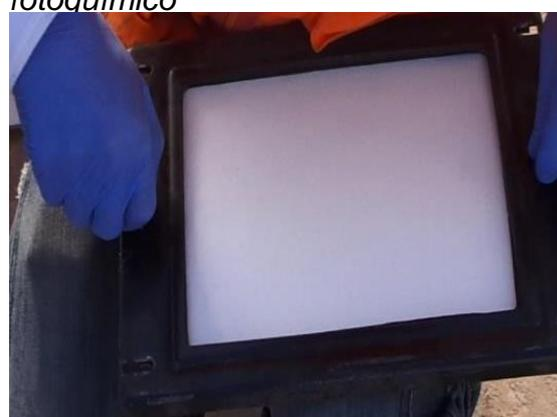
*Figura 45: Instalación de filtro a porta filtro*
