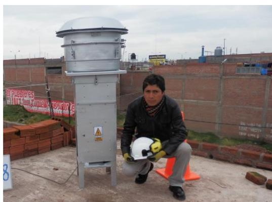
*Figura 47: Instalación de equipo Hi-Vol*
