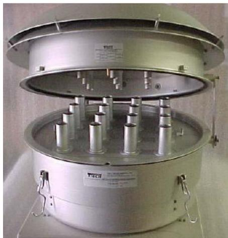
**Figura 2:** Separador Inercial de Boquillas Opuestas Hi – Vol.
