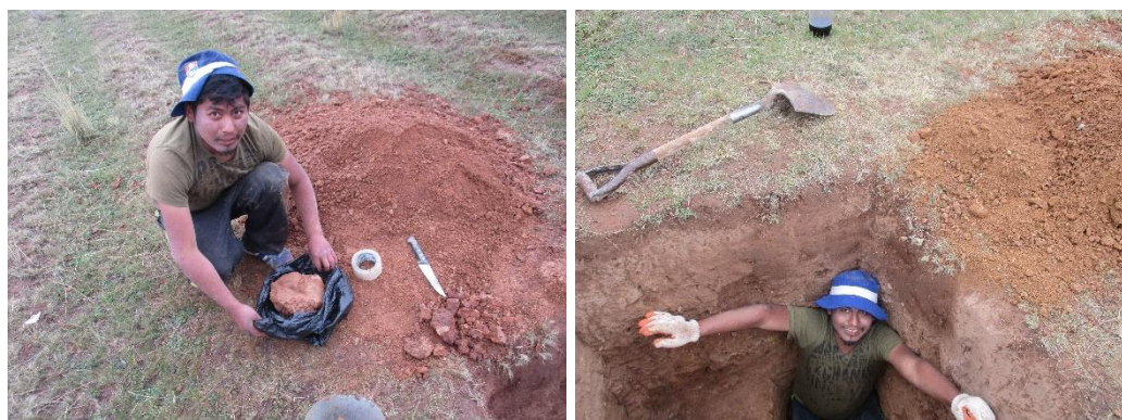
Figura 3.14. Calicatas Escavadas para la Obtención de Muestras en la Zona del Relleno Sanitario Para la Disposición Final de los RSU Para el Distrito de Asillo.
