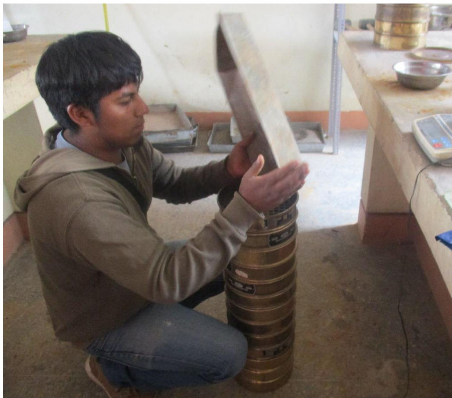
Figura 3.19. Realización del Ensayo de Análisis Granulométrico de las Muestras del Relleno Sanitario para la Disposición final de los RSU para el Distrito de Asillo.
