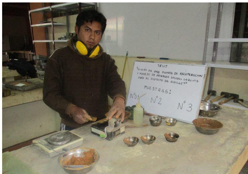
Figura 3.17. Realización del Ensayo de Limite Líquido de las Muestras del Relleno Sanitario Para la Disposición Final de los RSU Para el Distrito de Asillo.
