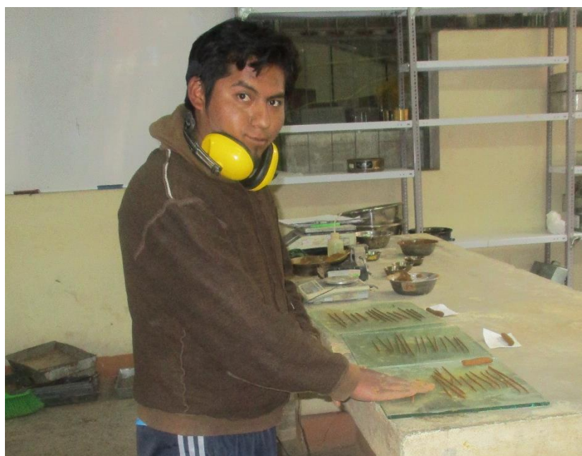
Figura 3.18. Realización del Ensayo de Limite Plástico de las Muestras del Relleno Sanitario para la Disposición Final de los RSU Para el Distrito de Asillo.
