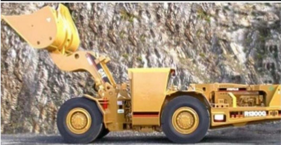
Figura N° 1: Perfil del equipo LHD (Scoop R-1300)
