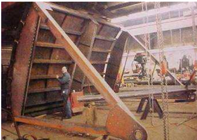
Fig. 7: Compuertas radiales Taintor.
