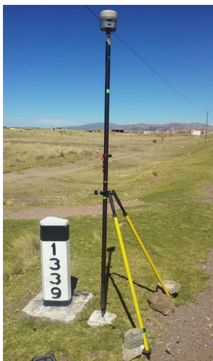
Figura 13. Estación Puntos de Control Carretera Puno - Juliaca
