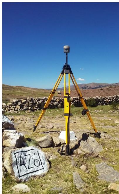
Figura 12. Estación Puntos de Control
