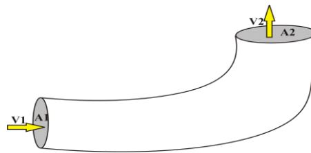
Figura 1: Ducto o Tubería. Fuente: (López García & Ramón, 2007)
