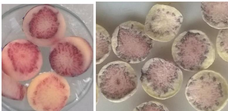
Variación de color de las muestras, izquierda: rodajas de ocas frescas, derecha: muestras de ocas secadas a 15 °C y 50 kHz.
