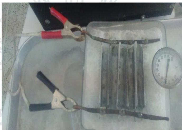
**Figura 9. Electrodo de hierro y aluminio en la electrocoagulación**
