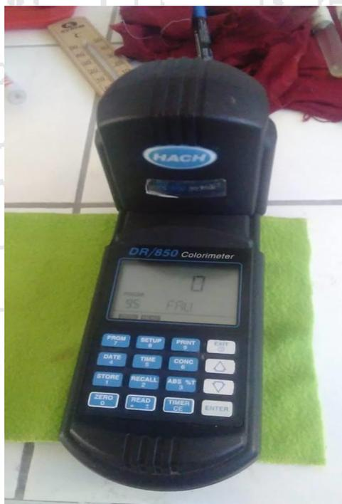
Figura 26. Equipo HACH para medición de Turbiedad de L.C.C.S. de Ingeniería Química-UNA PUNO, 2016
