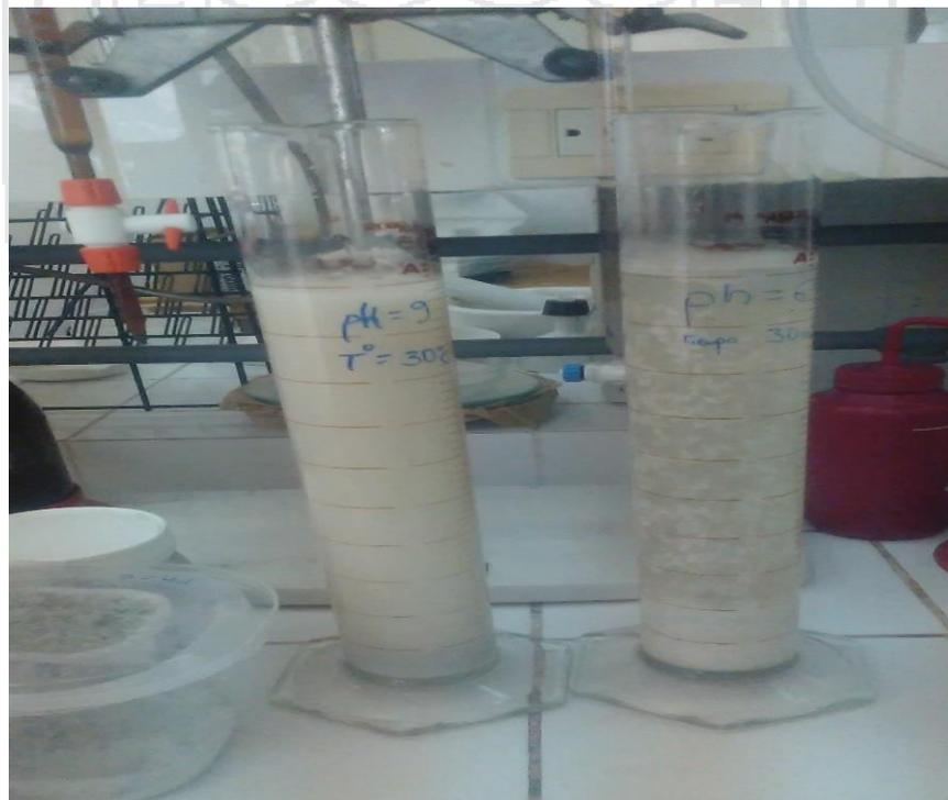
**Probetas con lactosuero electro coagulado luego de sedimentación de 48 horas**
