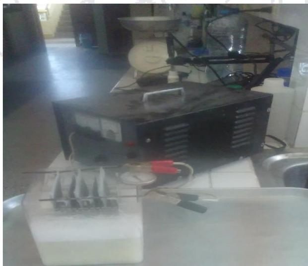
**Figura 11. Equipo de electrocoagulación con tres electrodos aluminio y hierro.**
