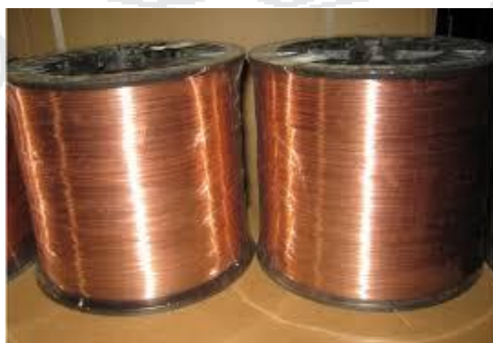
FIGURA 15: Alambres de cobre utilizados AWG 24, AWG 26
