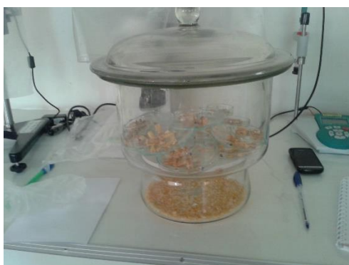
Fotografía 8. Papa seca enfriada en una campana desecadora para humedad
