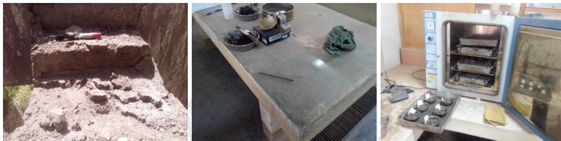
Figura 3.23. Caracterización física de adobes y mortero de pega - a.
