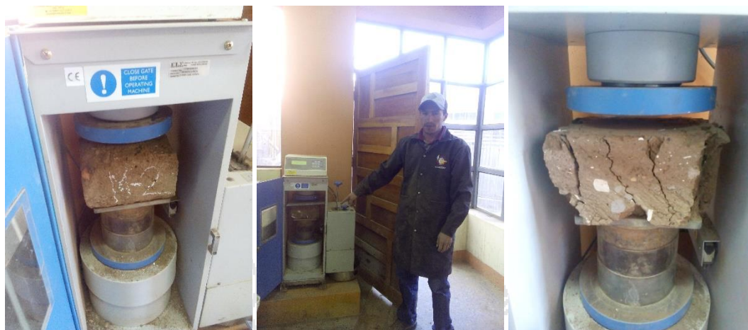
Figura 3.25. Caracterización mecánica – Ensayo de compresión sobre adobes.
