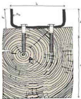
Figura 2.42. Reforzamiento estructural mediante perfil metálico (Enríquez, 2014).
