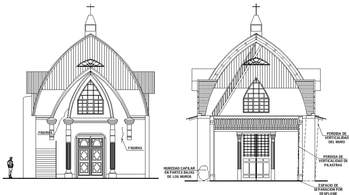
Figura 3.18. Daños visibles lado oeste de la Capilla, según trabajos de campo.
