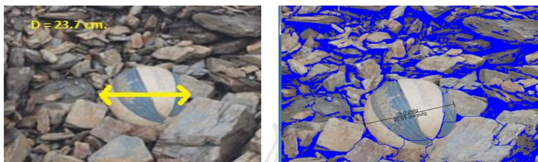
Figura 23: Fotos de la fragmentación en la voladura de desquinche.
