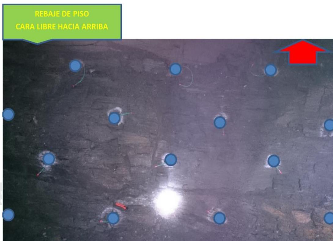
Figura 22: Secuencia de salida en rebaje de piso
