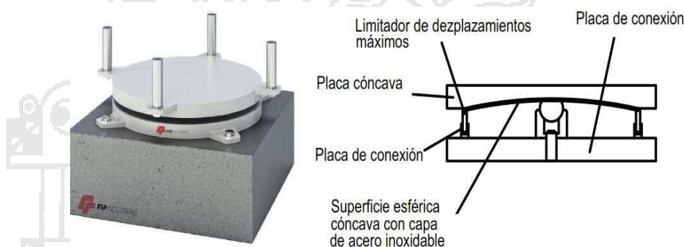
Ilustración 16: Aislador péndulo friccional 20 .
