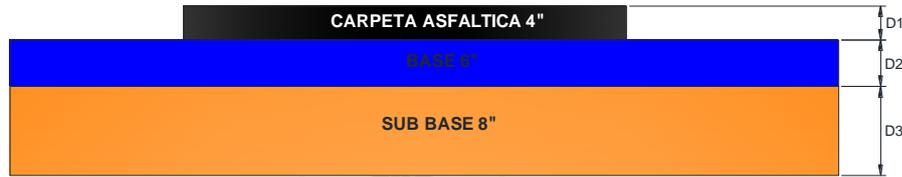
Figura 26:Espesores del pavimento, Fuente: Elaboración Propia
