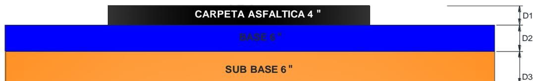
Figura 27:Espesores del pavimento, Fuente: Elaboración Propia
