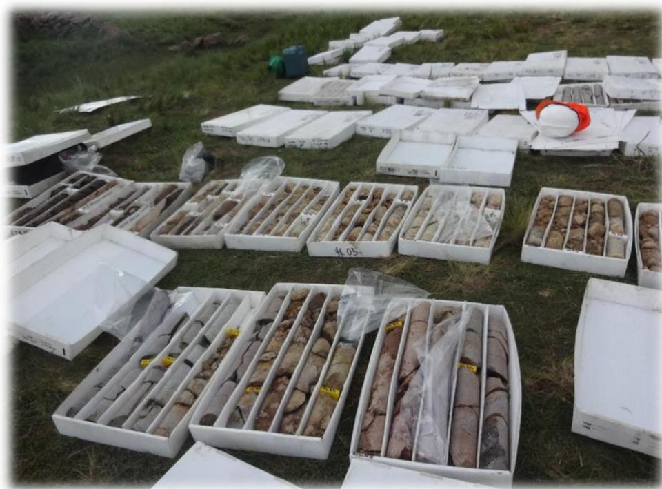
Figura N° 14: Logueo geotécnico de los sondajes diamantinos.
