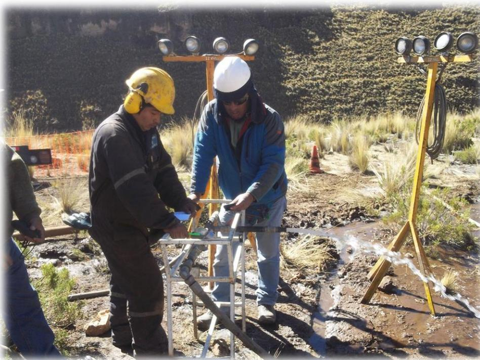
Figura N° 13: Ejecución de pruebas de permeabilidad dentro del sondaje.
