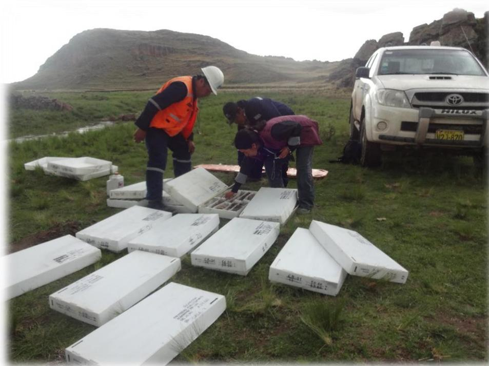
Figura N° 21: Evaluación geotécnica de los sondajes.
