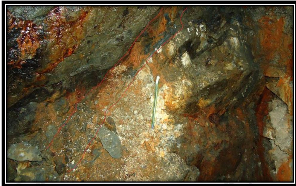
**Figura N° 12:** Fotografía tomada en dirección NW, desde las coordenadas UTM 479525E Y 8392450N. Se observa roca pizarra con estructura mineralizada con una Potencia: +/- 0.20cm contiene cuarzo blanco gris azucarado junto con óxido de hierro y sulfuro.
