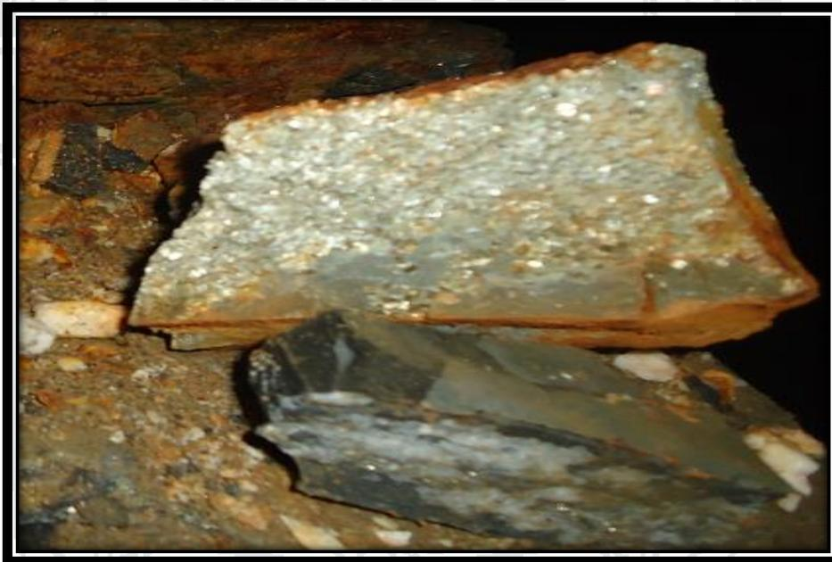
**Figura N° 15:** Roca pizarra con composición mineralógica afánitico y con foliación bien desarrollada, sus principales componentes minerales que se determinan en el microscopio son biotita, clorita, calcita, sericita, arcillas, limos, fragmentos de cuarzo, materia orgánica y otros muy pequeños soldados entre sí.
