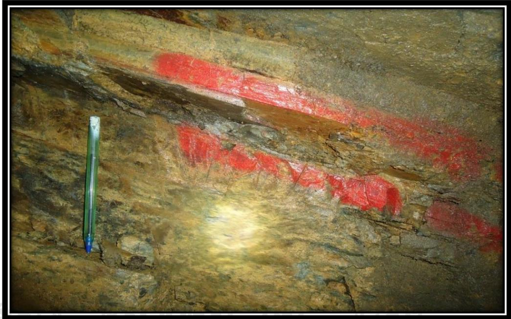
**Figura N° 18:** En la fotografía se observa micro fallas en la roca pizarra fracturada en láminas con relleno de arcilla, cuarzo y limonita
