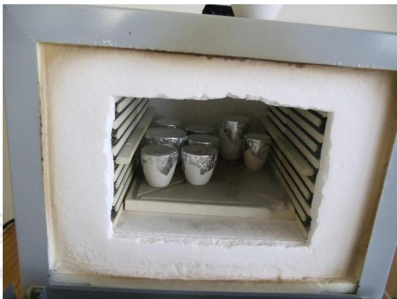
**FIGURA 23. PROCESO DE CALCINACIÓN DE MUESTRAS DE TRUCHA ARCO IRIS, PARA OBTENER CENIZA, UTILIZANDO UNA MUFLA MARCA THERMOLYNE Y MODELO 4800 N° F-48010-26, MEGALABORATORIO, UNA-PUNO, 2014.**
