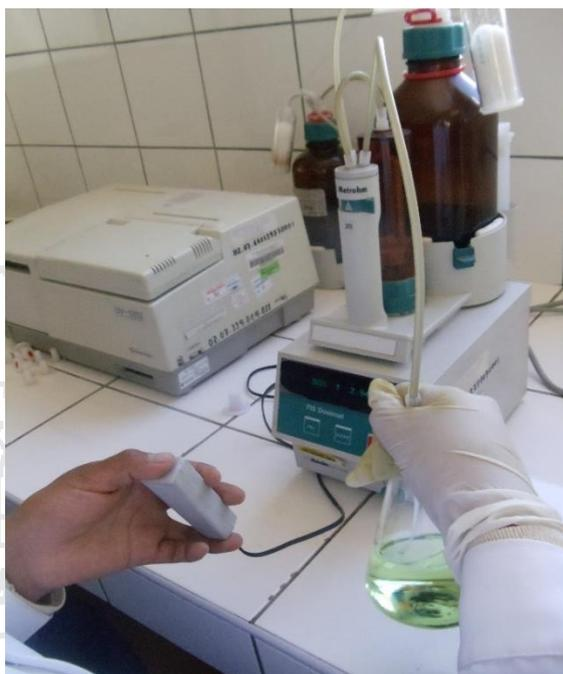
**FIGURA 25. TITULACIÓN CON BURETA AUTOMÁTICA PARA DETERMINACIÓN DE NITRÓGENO, UTILIZANDO TITULADOR KJELDAHL MARCA METROHYN SWISS MADE Y MODELO 715 DOSIMAT, MEGALABORATORIO, UNA.PUNO, 2014.**
