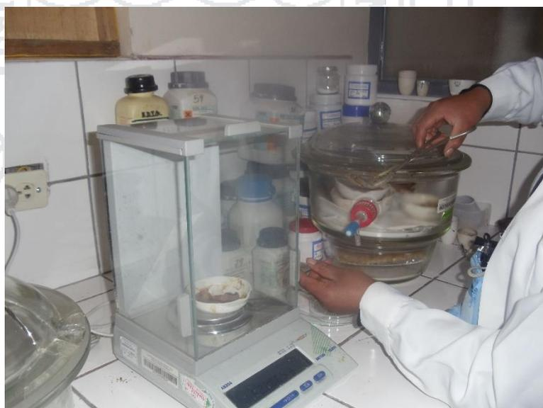
**FIGURA 22. PESADO DE MUESTRAS DE TRUCHAS ARCO IRIS EN BALANZA ANALÍTICA DE PRECISIÓN DE CAPACIDAD DE 210G, MARCA MATTLER TOLEDO Y MODELO AB204, MEGALABORATORIO, UNA-PUNO, 2014.**
