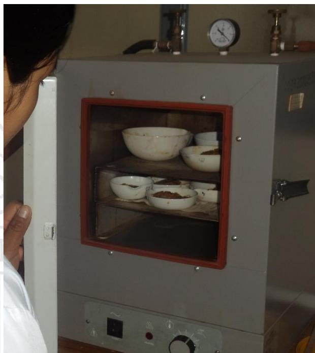
**FIGURA 21. PROCESO DE COCCIÓN DE MUESTRAS DE TRUCHAS ARCO IRIS, PARA ANÁLISIS DE HUMEDAD Y MATERIA SECA, UTILIZANDO UNA ESTUFA MARCA VWR SCIENTIFIC PRODUCTS VACUUM OVEN Y MODELO 1400E, MEGALABORATORIO, UNA-PUNO, 2014.**
