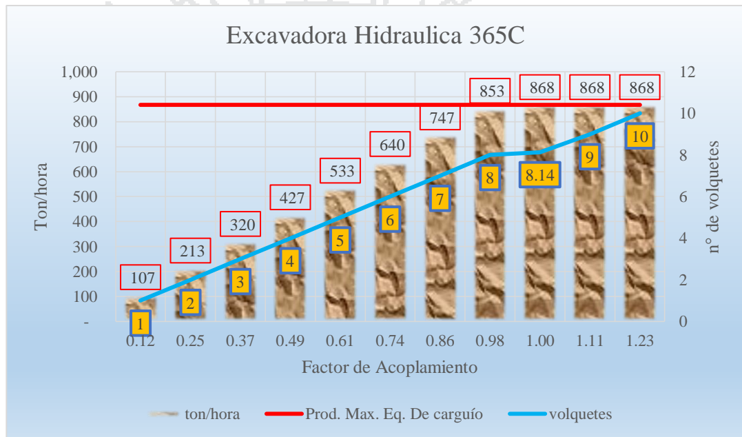
Figura 4.3 Factor de Acoplamiento con la Excavadora 365C para el desmante
