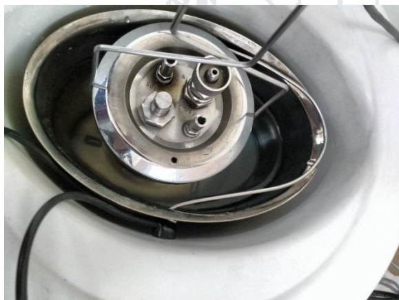
Foto 37. Sumergiendo la bomba calorimétrica.
