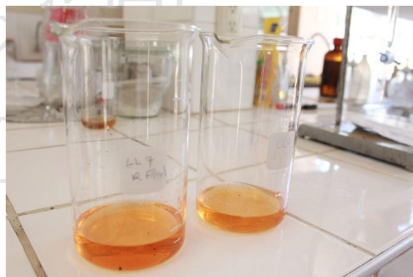
Foto 41. Cambio de calor a salmón luego de adicionar la solución de carbonato de sodio.
