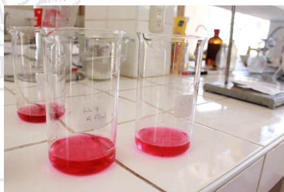
Foto 40. Titulación de contenido de ácido nítrico y H_2SO_4 .
