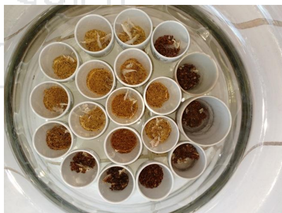
Foto 35. Muestras en crisol para determinar MS corregida.
