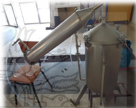
Foto N°2. Extracción del aceite esencial muña.
