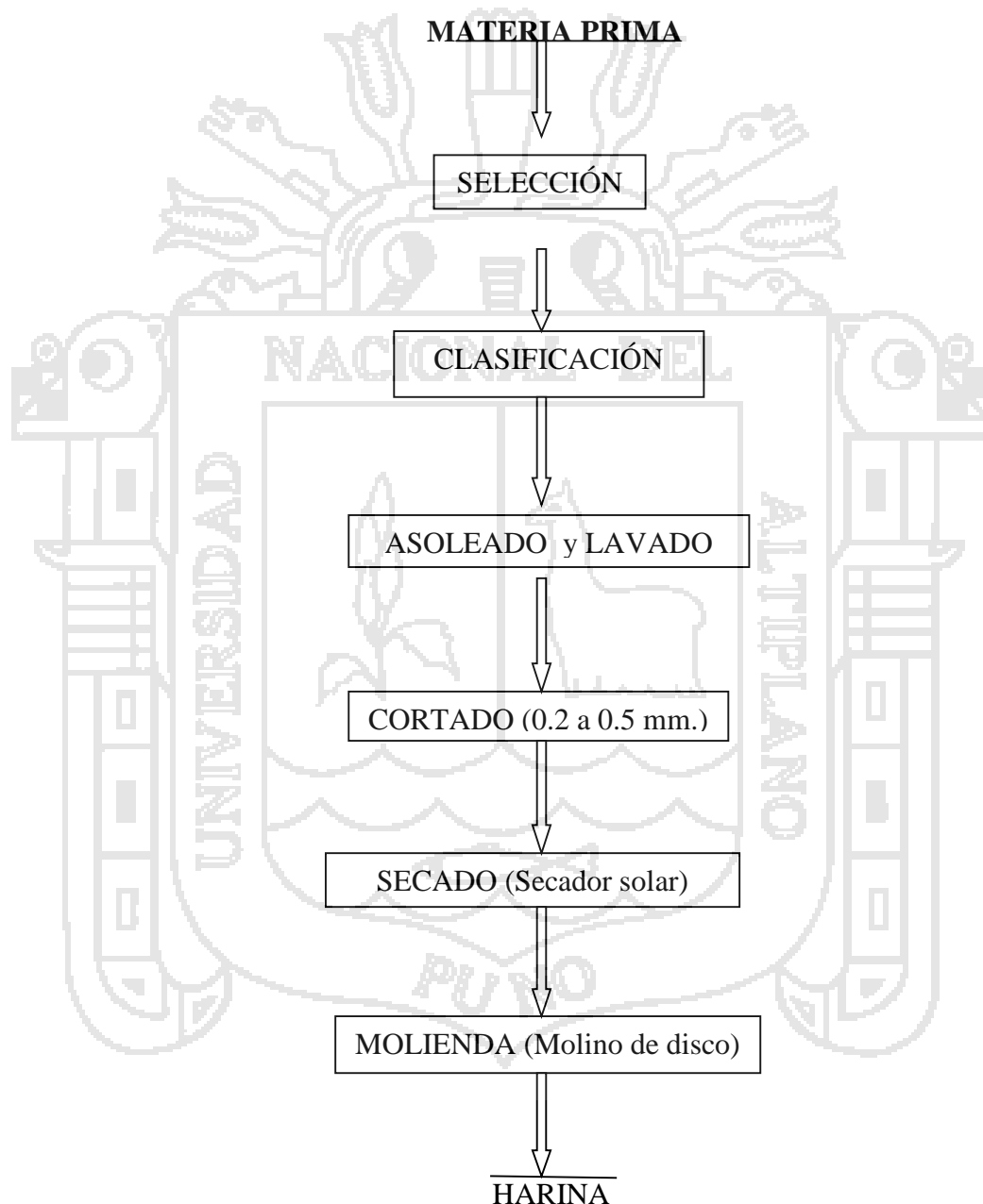
FIGURA N° 1: DIAGRAMA DE FLUJO PARA LA OBTENCIÓN DE HARINA DE OCA
