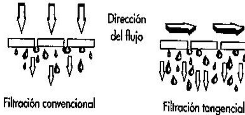
**Diferencias en la dirección del flujo en la filtración tangencial y la convencional.**
