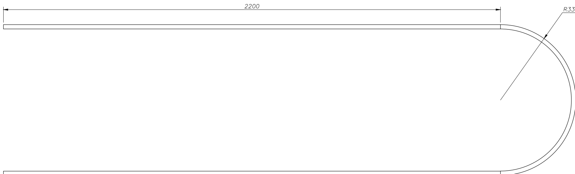
VISTA - LATERAL ITEM 10 - 12 ESCALA 1:10 CANT : 02 UND
