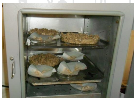
Foto N° 15: Tratamiento térmico y/o secado de la biomasa (salvado de cebada)
