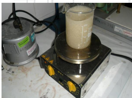
Foto N° 21: Prueba II efecto del tiempo de intercambio y/o contacto (biomasa activada-solución acuosa Pb(NO_3)_2 )
