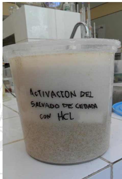
Foto N° 14: Activación acida de la biomasa con ácido clorhídrico
