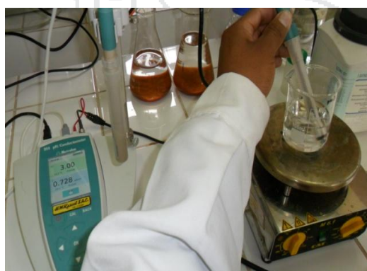
Foto N° 23: Prueba III efecto del pH (ajuste de la solución acuosa a diferentes pHs con HCL Y NaOH)
