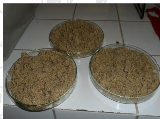
Foto N° 16: Re pulverizado de la biomasa (salvado de cebada) para su uso como material bioadsorbente
