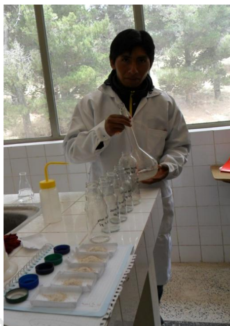
Foto N° 19-20: Preparación de la solución acuosa Pb(NO_3)_2 para determinar el grado de adsorción de la biomasa activada
