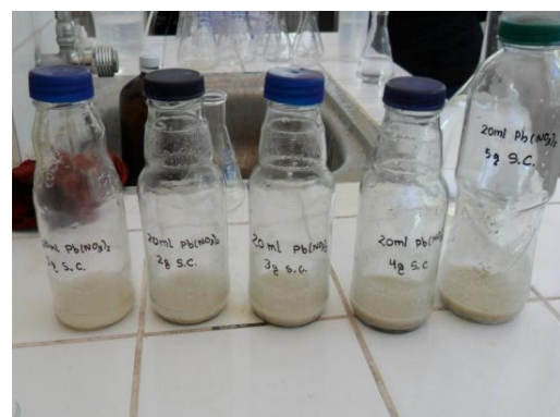
Foto N° 18: Prueba I efecto de la concentración del bioadsorbente en una solución acuosa de Pb(NO_3)_2
