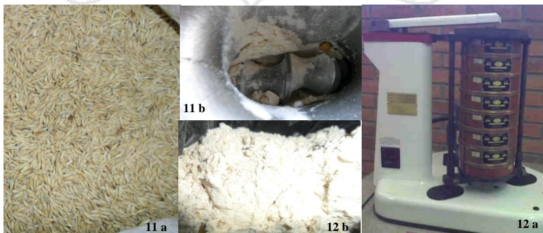
Foto N° 11 a-b y 12 a-b: Tratamiento granulométrico (molido y tamizado) del salvado de cebada
