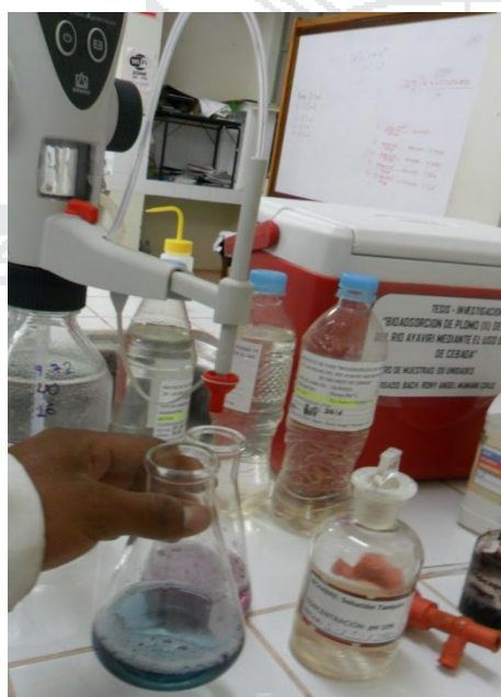
Foto N° 27: Análisis de las muestras por el método complexométrico
