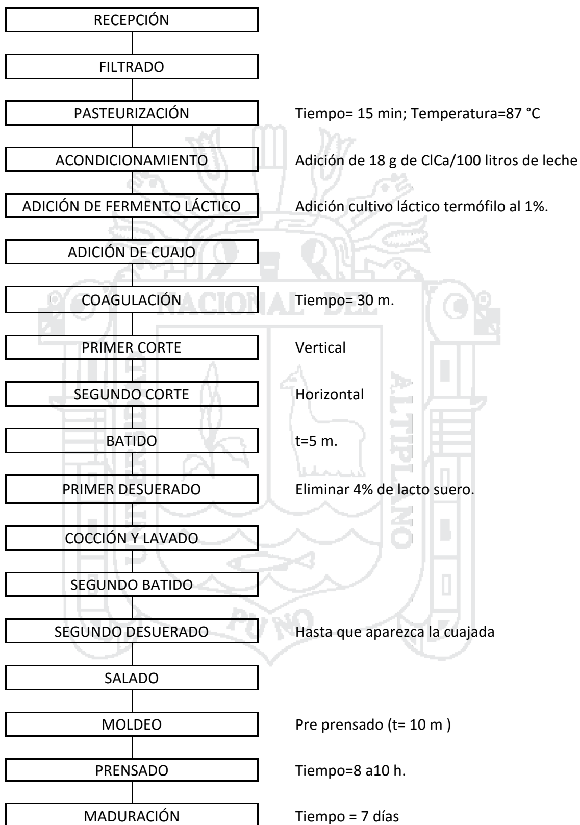
GRAFICAS N° 1: Diagrama de flujo de elaboración de queso tipo paria
